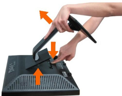
**ANMERKUNG:** Der Monitor muss unbedingt auf eine saubere Oberfläche gelegt werden, um Kratzer auf dem Bildschirm beim Entfernen des Monitorfußes zu vermeiden.
