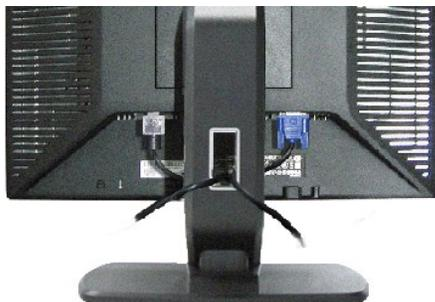
Verwenden Sie nach dem Anbringen aller erforderlichen Kabel an Ihren Monitor und den Computer (siehe [Anschließen des Monitors](#) für Hinweise zu dem Anschließen der Kabel) den Kabelhalter, um sämtliche Kabel wie oben abgebildet sauber zu verlegen.
